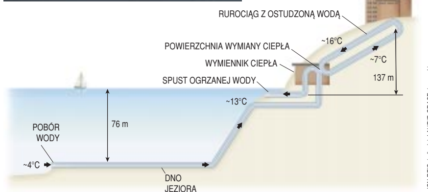
SCHEMAT CHŁODZENIA: rurociąg z jeziora Cayuga, którego pierwszy odcinek jest już ułożony (zdjęcie), doprowadzi zimną wodę do urządzeń klimatyzacyjnych Cornell University.
